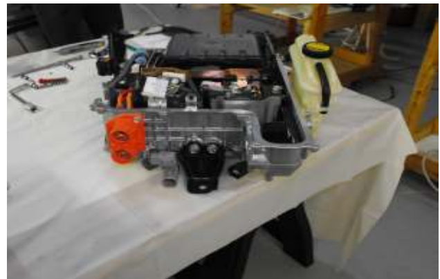
Figura 3. Sistema Inversor desmontado.
