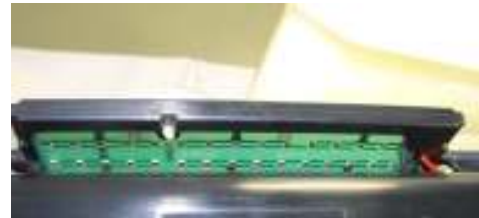
Figura 7. Resistencias de descarga
