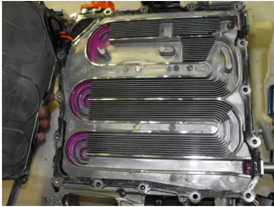
Fig.4 Ductos de conducción de líquido refrigerante.
