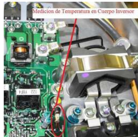
Figura 12. Sensor de temperatura en el inversor.
